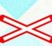
T-27a Kontrolsüz Demir Yolu Geçidi (Tek Hat)
